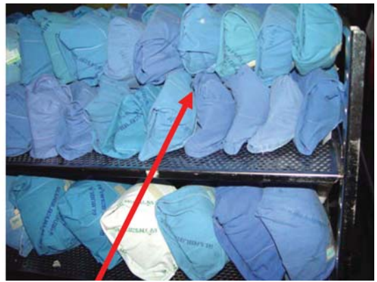
จัดเรียงชุดอุปกรณ์ผิดวิธีทำให้ไม่สามารถไล่อากาศและน้ำที่เกิดออกหมด
