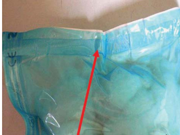
การปริหรือแยกของรอยผนึกในช่อง Peel Pouch หลังทำให้ปราศจากเชื้อ
