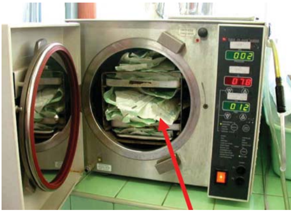
จัดเรียงชุดอุปกรณ์ผิดวิธีทำให้ไม่สามารถไล่อากาศและน้ำที่เกิดออกหมด
